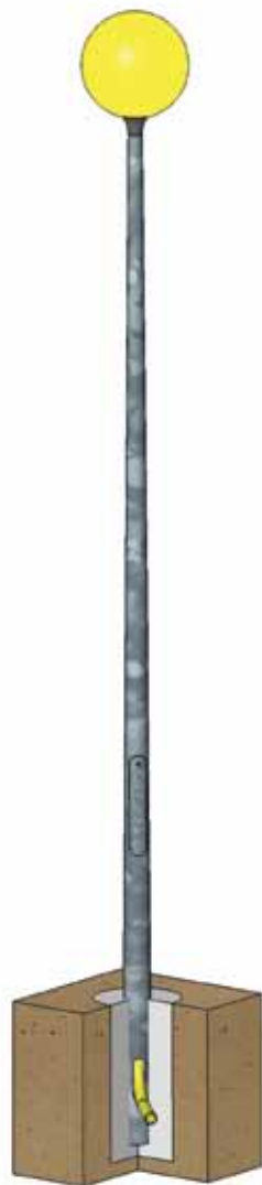
Установка опоры КК в грунт.
