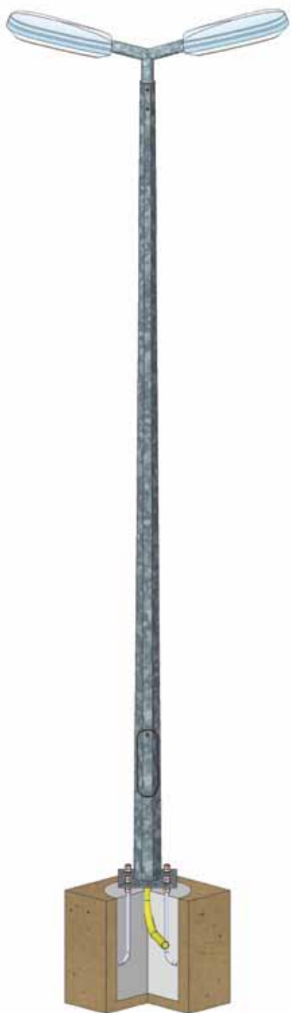
Установка опоры МК на анкерные болты с применением кондуктора.
