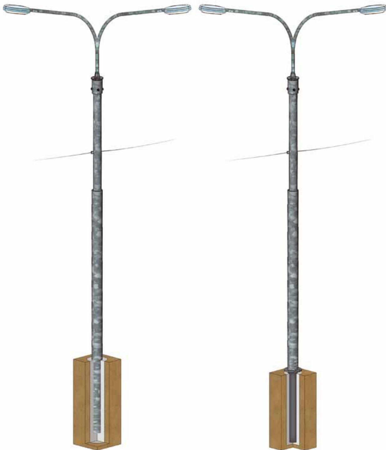
Установка опоры СП в грунт.
