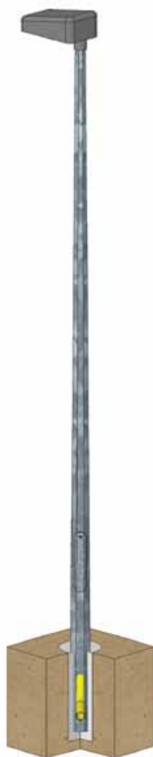
Установка опоры МК в грунт.
