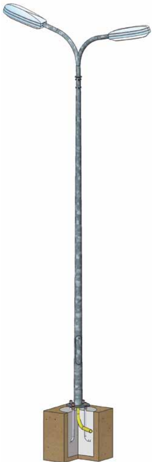
Установка опоры КК на анкерные болты с применением кондуктора.
