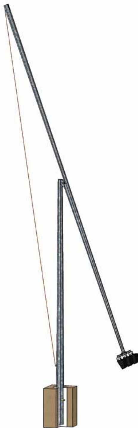
Установка опоры МТ в грунт.
